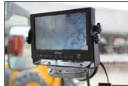
Monitor zur Rückfahrkamera
