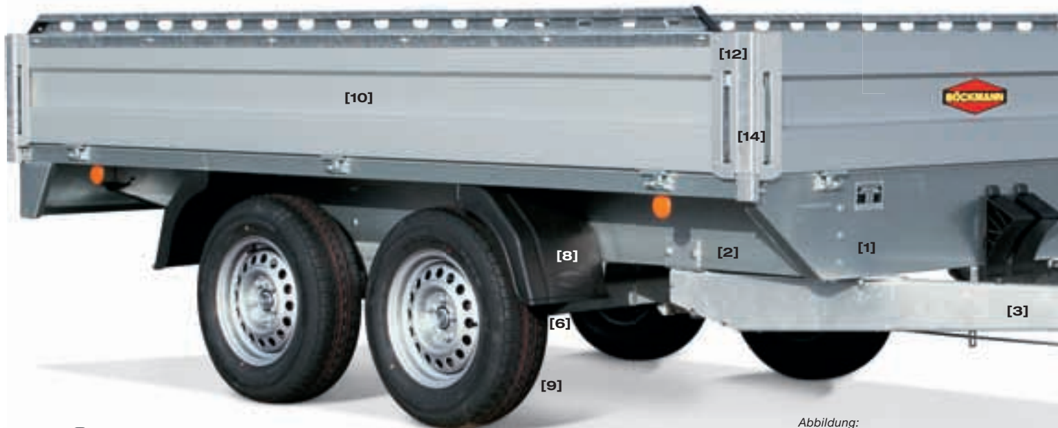
Abbildung: Hochlader, Tandem-Modell, gebremst, mit Seitenwandgalerie (Zubehör)
