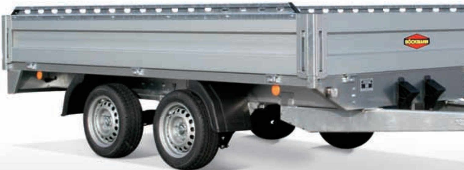
Abbildung: Hochlader mit niedriger Ladehöhe, Tandem-Modell, gebremst, mit Seitenwandgalerie (Zubehör) und WCFplus-Fahrwerk (Zubehör)
