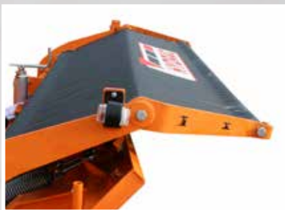
Schneestaubschutz Stufenlos verstellbare Plane Überhangweite 400 mm
