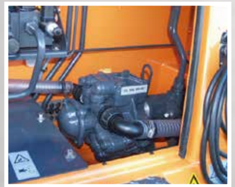
Wartungsfreundlich aufgebautes Flüssigkeitssystem, mit leistungsstarker Kolbenmembranpumpe.
