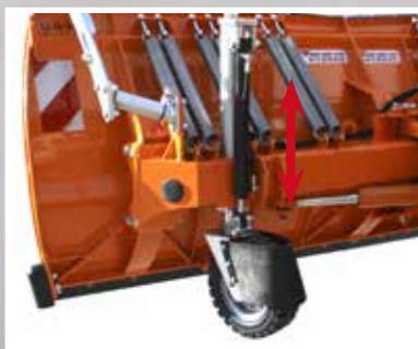
Hydraulisch verstellbare Räder Höhenverstellung der Nachlaufräder von der Kabine aus. 1 Doppelwirkendes Steuergerät notwendig. DM 360 mm
