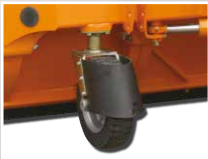
Nachlaufräder Stufenlos höhenverstellbar durch Spindel. Vollgummi- oder Lufträder.
