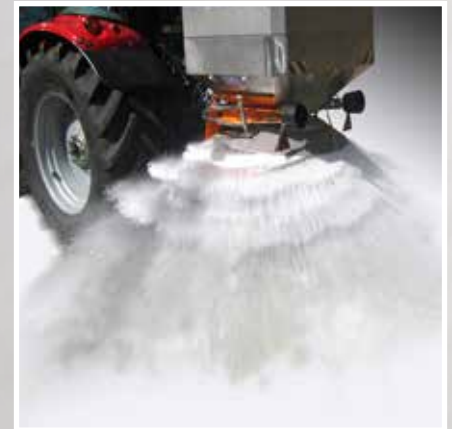
Streubreite von 1,5 - 6 m Streubildverstellung Links - Mitte - Rechts
