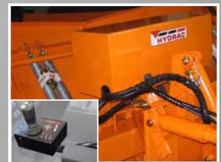
Elektro-Hydraulik-Anlage für LKW mit Bedienpult. Montiert am Schneepflug. (z.B. für Fahrzeuge ohne Hydraulik) 12V oder 24V
