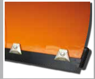
Klemmsystem Schnellspanvorrichtung zum Befestigen der Stahl- und Kombi- Schürfleiste
