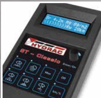
Wegabhängige Steuerung für vollautomatische Mengenregulierung abhängig von der Fahrgeschwindigkeit.
