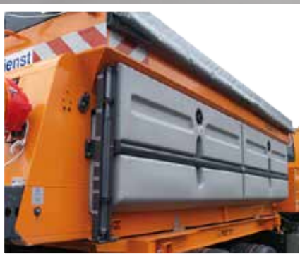
Seitentanks die mit der Außenkontur des Streuautomaten abschließen.
