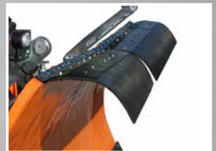
Schutzschirm aus Stahl-Gummielementen Überhangweite 400 mm
